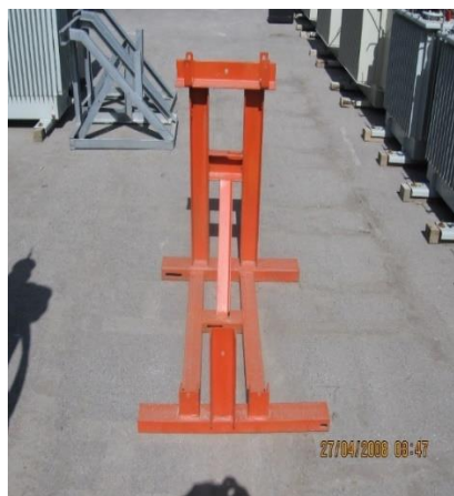
شکل ۲۲- سکوی مونتاژ اولیه طراحی شده برای آماده سازی پست هوایی یکپارچه در محل انبار
