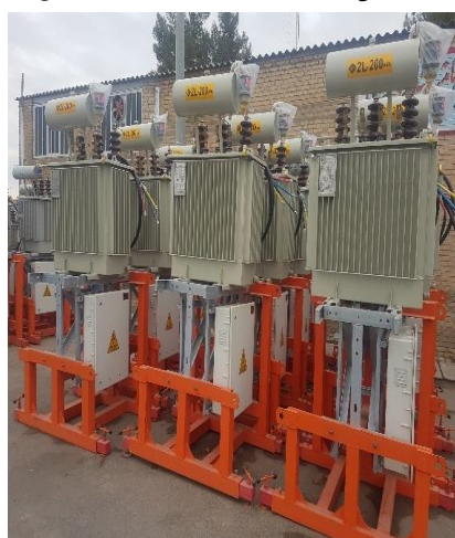
شکل ۲۳ نمونه پست های هوایی یکپارچه مونتاژ شده و آماده برای نصب در انبار (نمونه اول)
