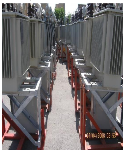
شکل ۲۳ نمونه پست های هوایی یکپارچه مونتاژ شده و آماده برای نصب در انبار (نمونه اول)
