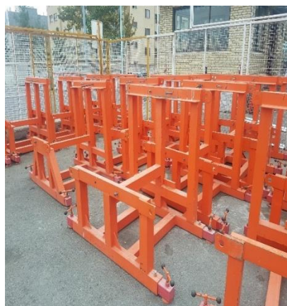
شکل ۲۲- سکوی مونتاژ اولیه طراحی شده برای آماده سازی پست هوایی یکپارچه در محل انبار
