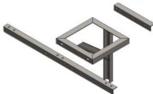
شکل ۱۷- مدل‌های سکوی کات اوت و برقگیر در پست‌های هوایی یکپارچه
