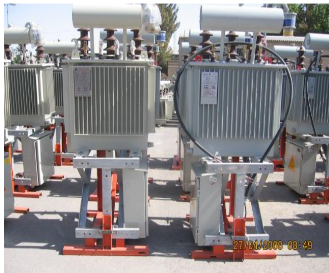
شکل ۱- تصویر پست هوایی یکپارچه مونتاژ شده در انبار و نصب شده در شبکه
